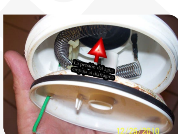
Figura #4: Conductor de puesta a tierra Termoducha. [5]
